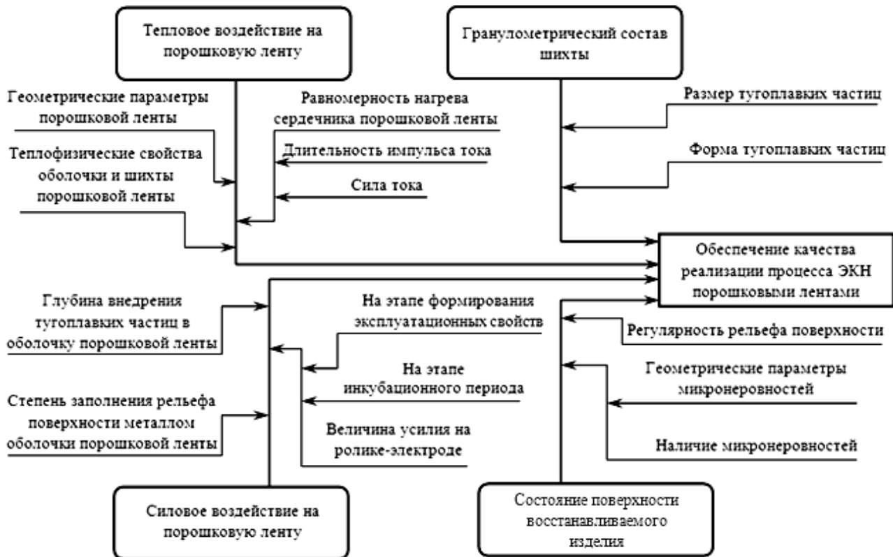
Рис. 1. Структура факторов, влияющих на показатели качества технологического процесса электроконтактной наплавки порошковыми лентами
